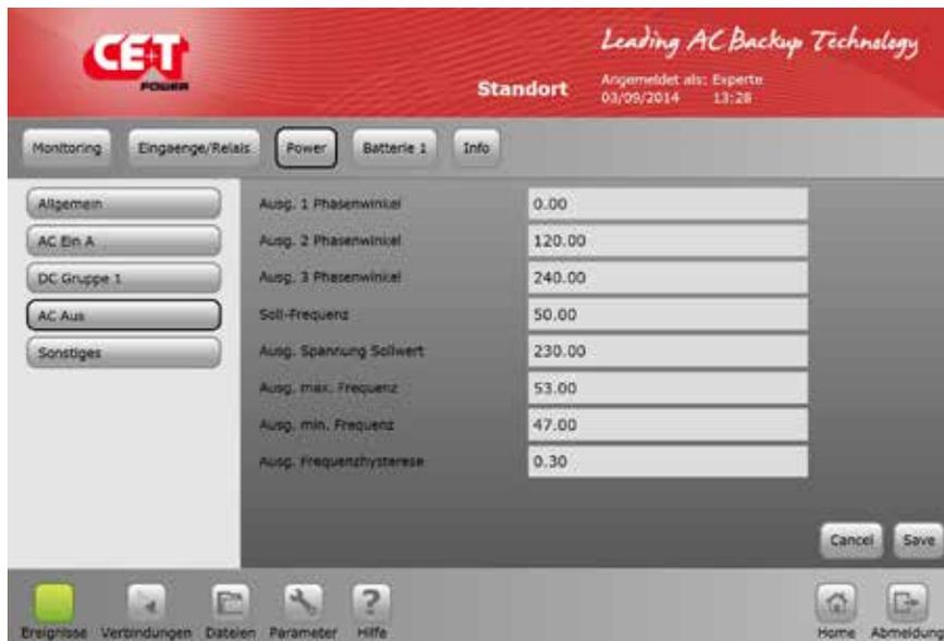
AC Ausgang AC Ausgangsspannung einstellen, Frequenzbereich und Phasenfolge.
