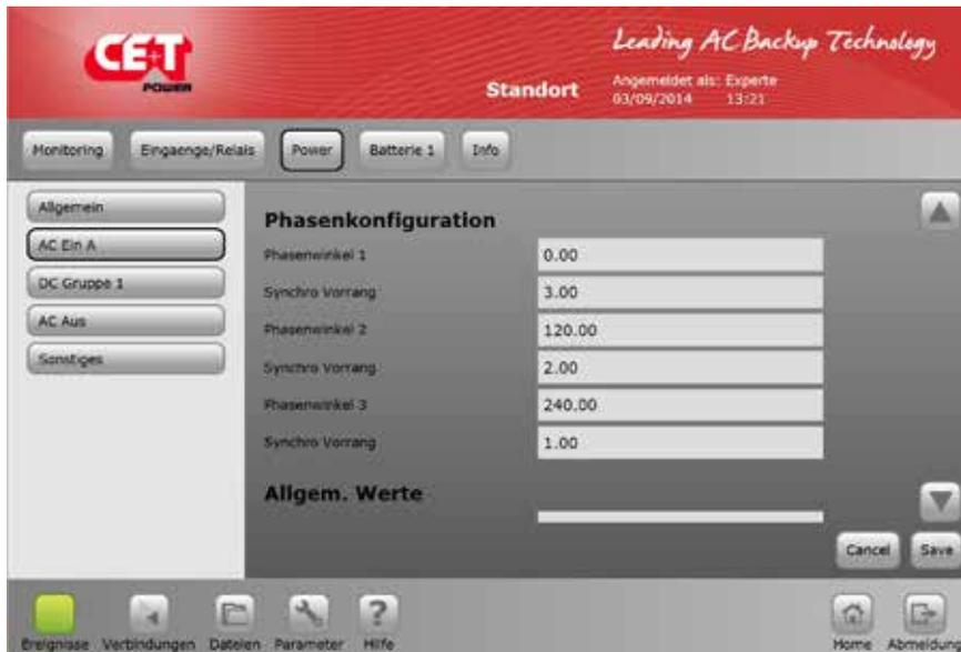
Definieren Sie Phasenverschiebung und die Priorität für die Synchronisation. Wenn Phase 3 fehlt, dann wird Phase 2 die priorisierte sein.
