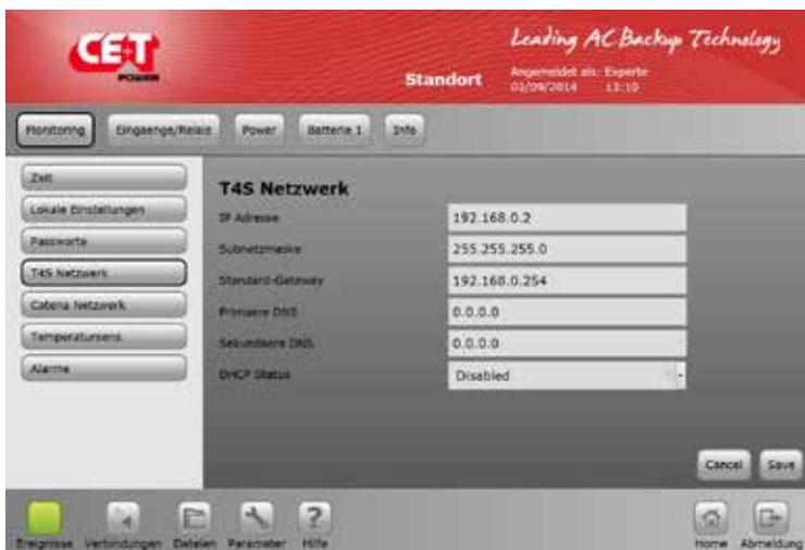
Netzwerk T4S => Parameter für die Fernverbindung über Ethernet-Schnittstelle eingeben.
