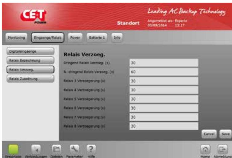
Bei Relais Verzögerung kann die Verzögerungszeit nach einem Ereignis in Sekunden angegeben werden, nach der das Relais seinen Zustand ändert.
