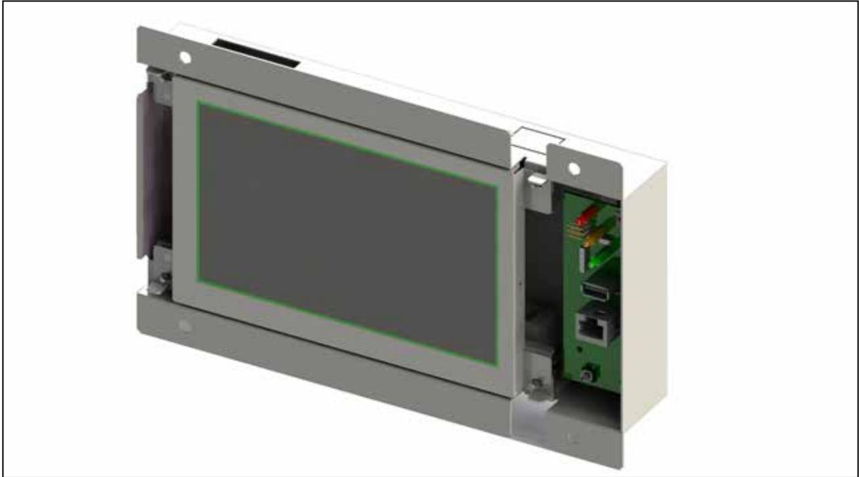
Bitte beachten Sie, dass, wenn CATENA installiert ist, der Ethernet-Port des T4S nicht verfügbar ist. Er wird durch CATENA durchgeschleift.
